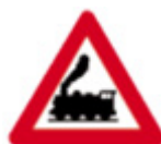
Figure 4 : signal A43 : passage à niveau sans barrières
