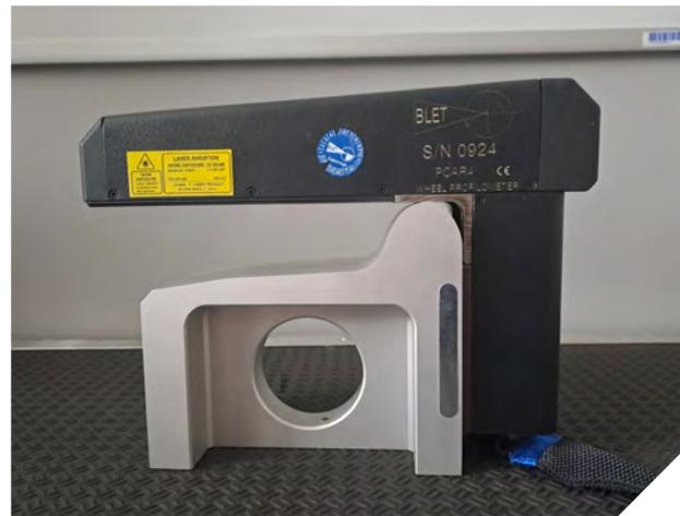
Die Profilometer für Räder von Eisenbahnrollmaterial und Profilometer für Schienen erlauben schnelle Laser-Messungen von diversen geometrischen Parametern sowie die Feststellung möglicher Schäden an den Profilen und/oder Abnutzungen an den Rädern und Gleisen.
