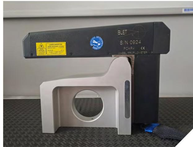
Les profilomètres pour roues de matériel roulant ferroviaire et les profilomètres de rail constituent une solution simple pour des mesures rapides de divers paramètres géométriques à l'aide d'un scan laser. Ils permettent de détecter d'éventuels défauts de profil et/ou d'usure de roues et de rail.
