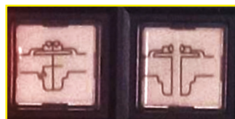
De lampen die de toestand "gekoppeld" (links) of de toestand "ontkoppeld" (rechts) aangeven in de stuurcabine.
