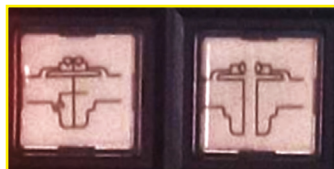
Lampes indiquant l'état « accouplé » (à gauche) ou « désaccouplé » (à droite) dans la cabine de conduite.
