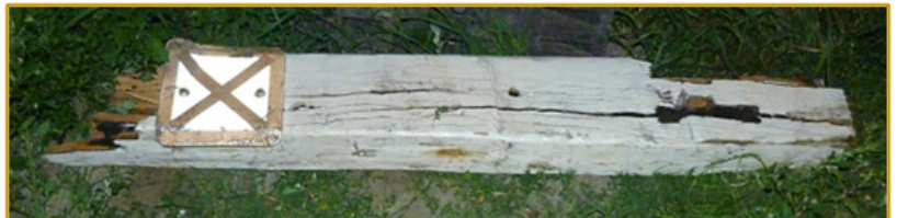
↓ Onderdeel van op het doodspoor 091 aangereden stootbok met merkbord
