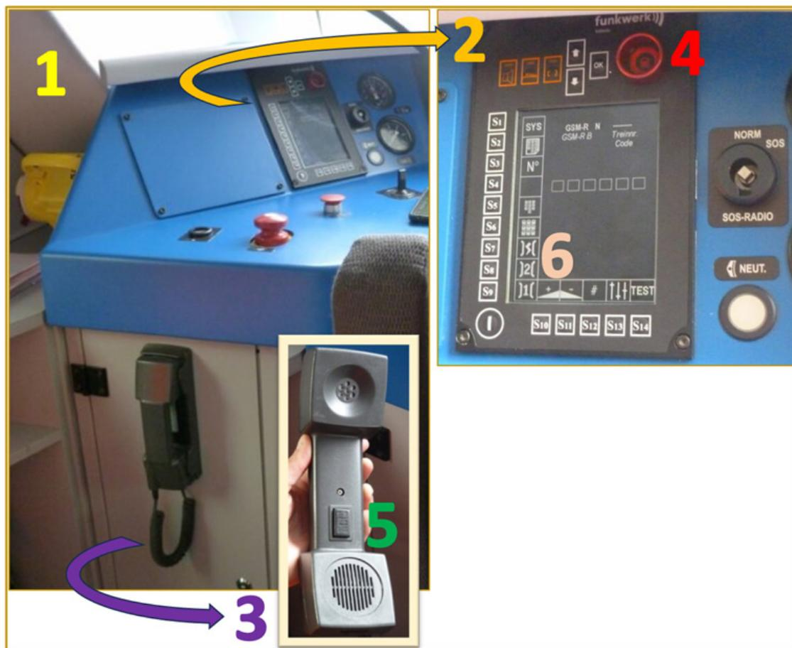
Le GSM-R dans le poste de conduite d'un conducteur de train (1) peut être positionné à un autre endroit selon le type de matériel roulant, mais son aspect, ses fonctionnalités et son fonctionnement sont toujours les mêmes. Le conducteur de train dispose, d'une part, du panneau de commande (2) et, d'autre part, du combiné du conducteur (3).
