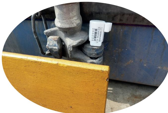
Ces 2 dispositifs empêchent tout contrôle du contenu du container une fois le container positionné sur le wagon.
