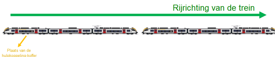
Illustratie van het dubbele stel dat trein E2189 vormt, met aanduiding van de plaats van de hulpkoppeling-koffer.
