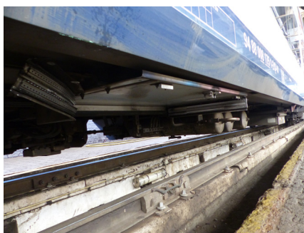
Zicht op de schade aan de onderkant van MR 8175 (foto's genomen in de werkplaats te Schaarbeek): koffer ontbreekt, schuifrails verbogen, beschadigde elementen.
