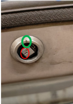
Zicht op een van de twee sloten van de hulpkoppeling-koffer van een Desiro: markering op het slot en vaste markering op de koffer .
