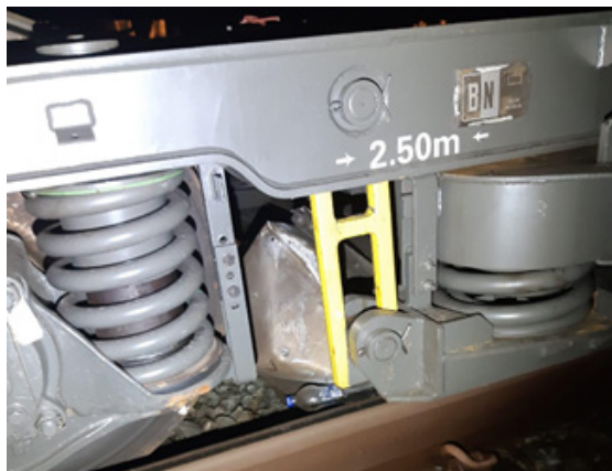
Hulpkoppeling-koffer van MR 08175 teruggevonden in het eerste draaistel van MR906 (bron NMBS).
