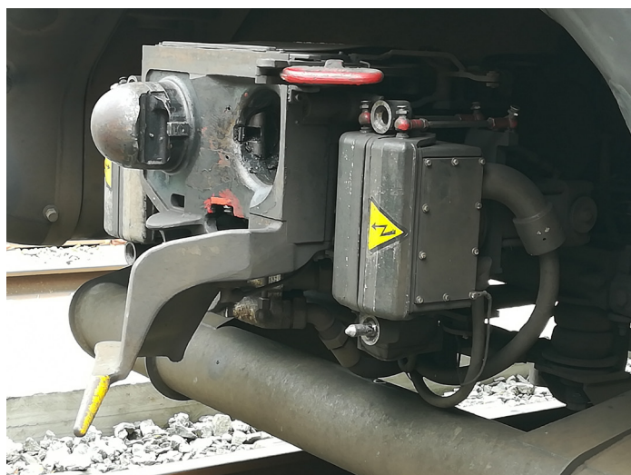
Volledig automatische koppeling van het merk "Georg Fisher".
