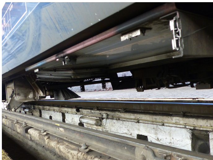
Zicht op de schade aan de onderkant van MR 8175 (foto's genomen in de werkplaats te Schaarbeek): koffer ontbreekt, schuifrails verbogen, beschadigde elementen.
