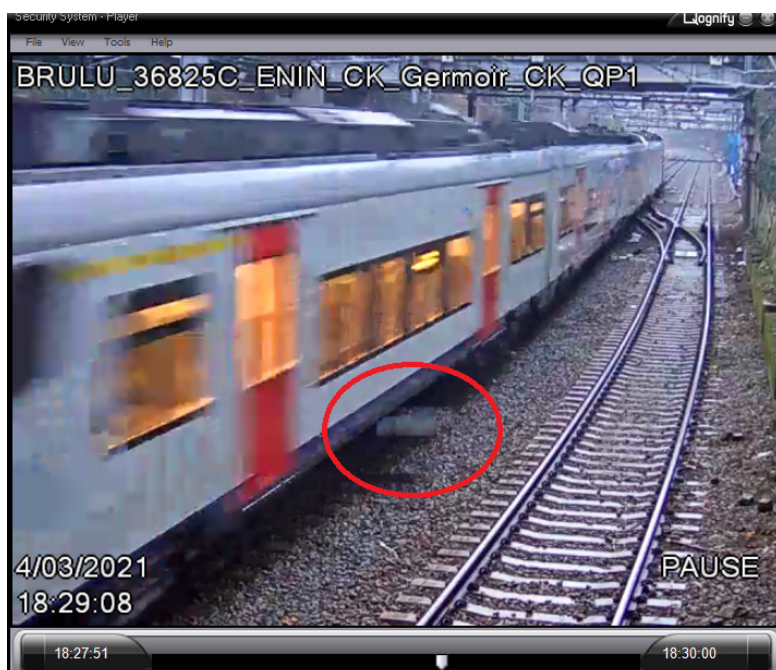
Screenshot van de door de NMBS verstrekte CCTV-beelden waarop de open hulpkoppeling-koffer van MR 8175 (in de rode cirkel) tussen het station Brussel-Luxemburg en de onbewaakte stopplaats Mouterij te zien is (bron: NMBS).
