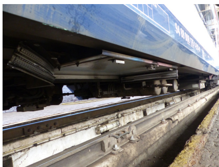
Zicht op de schade aan de onderkant van het MR 8175 (foto's genomen in de werkplaats te Schaarbeek): koffer ontbreekt, schuifrails verbogen, beschadigde elementen.
