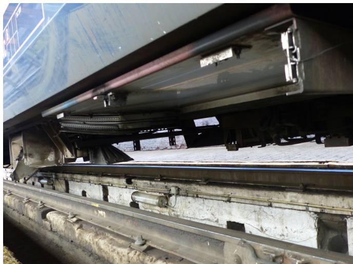
Zicht op de schade aan de onderkant van het MR 8175 (foto's genomen in de werkplaats te Schaarbeek): koffer ontbreekt, schuifrails verbogen, beschadigde elementen.
