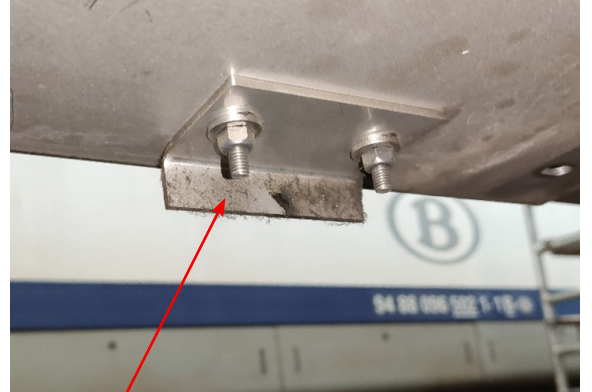
Vue de l'intérieur de la serrure du coffre d'attelage de secours : Patte de fermeture – Butée derrière laquelle doit se positionner la patte de fermeture.
