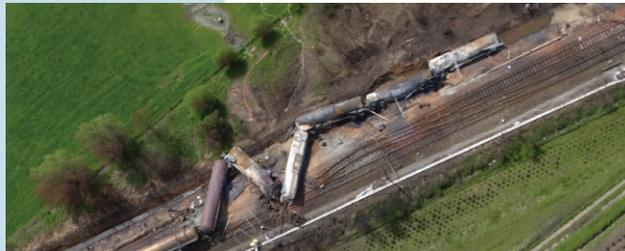
Le convoi transportait des matières chimiques soumises au RID dont 5 wagons transportant de l'acrylonitrile. Sur les 13 wagons que comportait la rame, 7 ont déraillé. Trois wagons sont tombés sur le bas-côté des voies et se couchent sur le flanc. Plusieurs citernes sont percées déversant leur chargement dans le fossé. Un incendie important se déclare dans les wagons citernes et se propage par le fossé.
