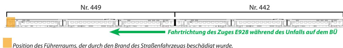
Der Führerstand des ersten Triebwagens (Nr. 449) wird stark beschädigt und diverse Bestandteile der Infrastruktur werden ebenfalls durch das Feuer angegriffen.
