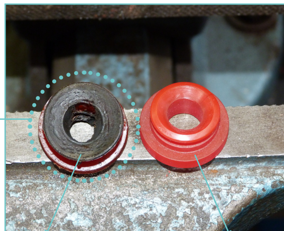
Dichting perslucht-kraan van de rem aangetast door de hitte
