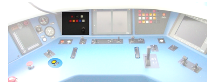
Afbeelding: besturingsconsole met de verklipperlichten TBL1+ en de kwiteringsknop.
