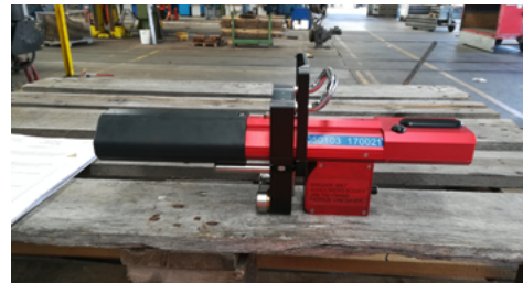
Afbeelding: het toestel voor de controle van het wielprofiel en van de afstand tussen de twee wielen van een as.
