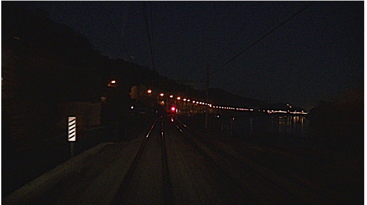
Afbeelding: zichtbaarheid en duidelijkheid van het rode sein B222 ter hoogte van het baken met 5 strepen - Let wel, de prestaties van de opname zijn minder goed dan die van het menselijke oog.
