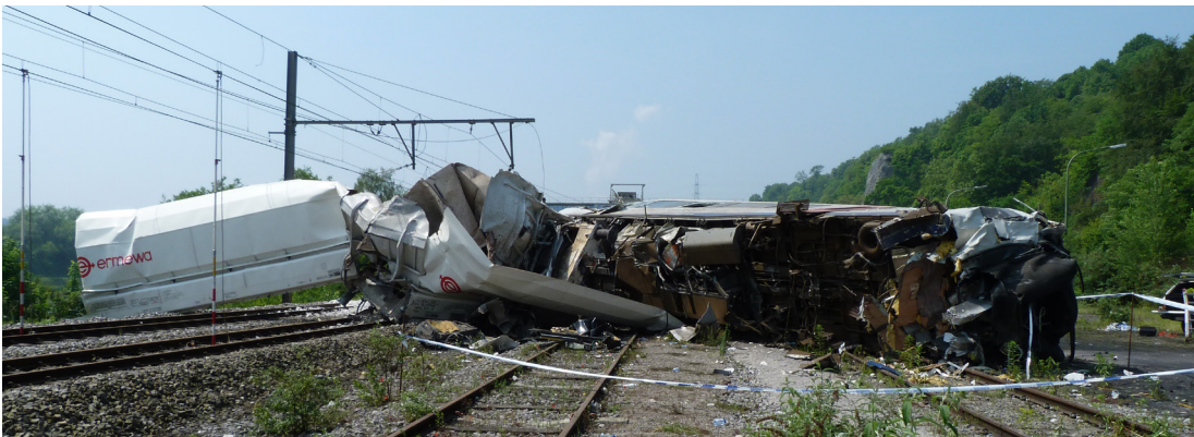
Afbeeldingen: laatste wagon van trein E48535, omgekiept en gescheurd bij de botsing - het wrak is verstrengeld met het kopvoertuig van trein E3820.
