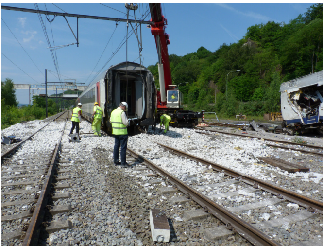
Afbeelding: witte kalkstenen (lading van de laatste wagon van trein E48535) zichtbaar op de plaats van de botsing tijdens de herspoeringswerkzaamheden.
