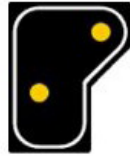
fig. 2.13: SEIN OP NORMAALSPOOR
