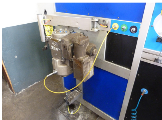
Meetbank waarop de te meten/testen verdeler werd geplaatst.
