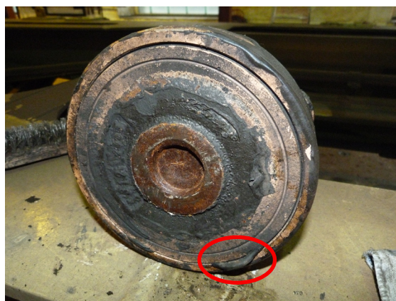
Lastweegventiel dat schade vertoont als gevolg van het ongeval (afdichting tevoorschijn gekomen).
