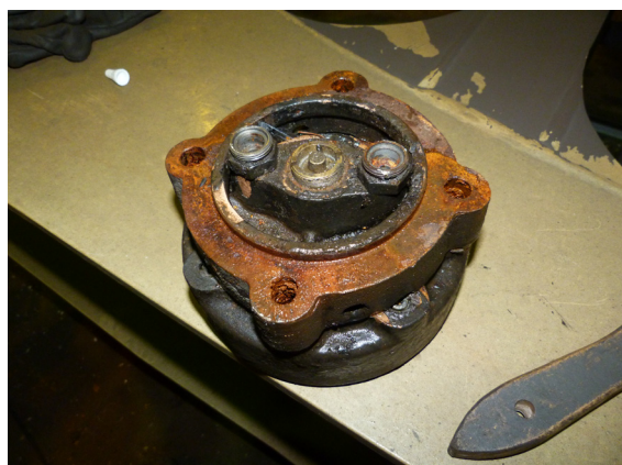
Gedemonteerde lastweegklep van draaistel 3-3' van wagon 33 68 4952 072-9.
