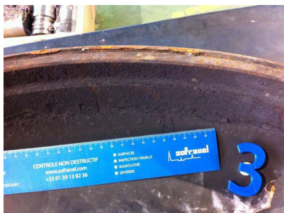
Illustratie van het verbrande lakwerk en de oxidatie op de wielstukken 3 en 4.
