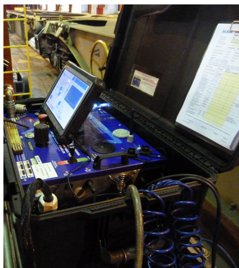
Halfautomatische testbank vóór wagon 33 68 4952 088-5.
