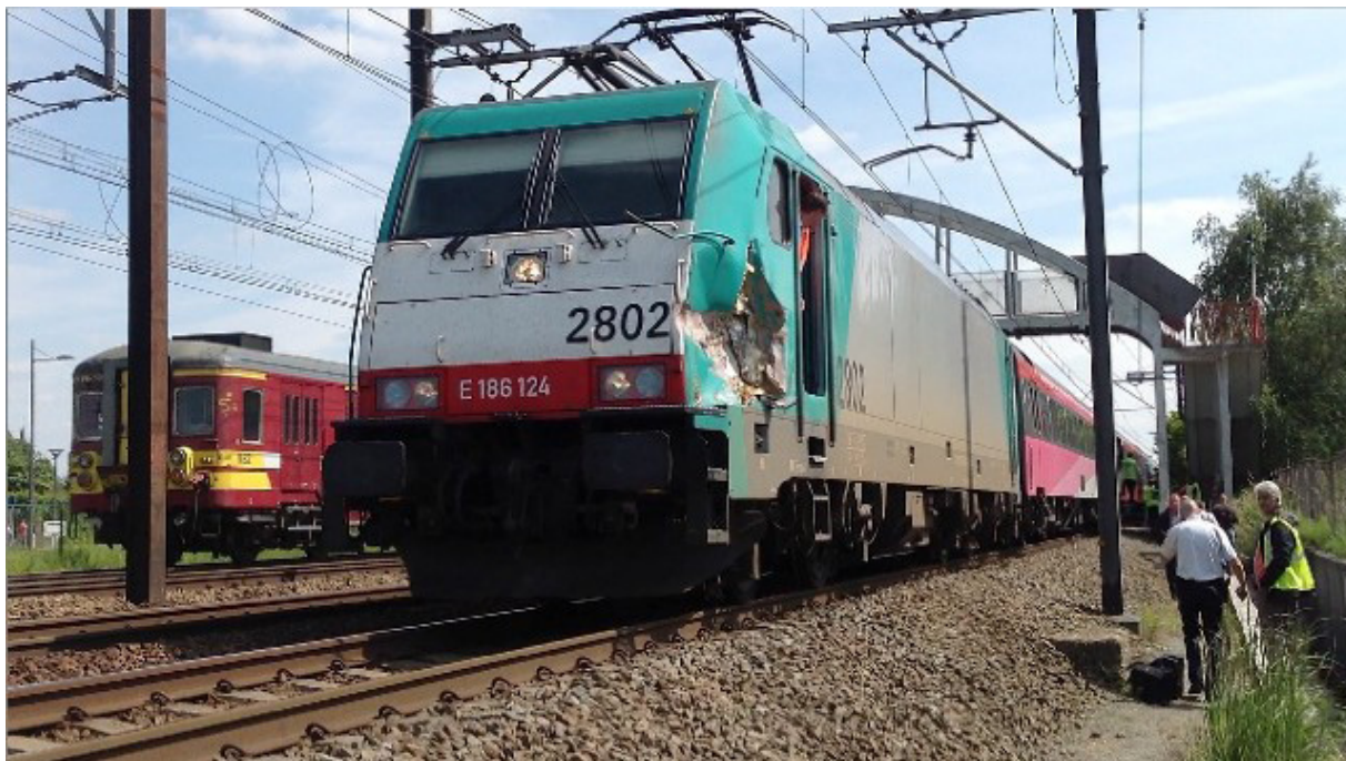
Afbeelding 5: Schade aan de locomotief na botsing met de arm van de graafmachine.
