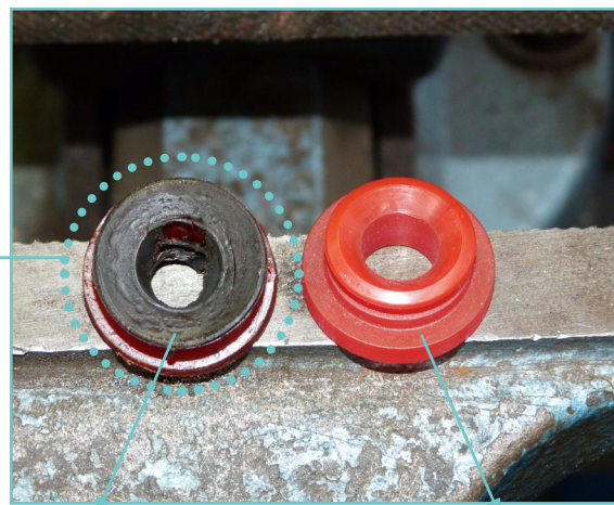
Joint du robinet à air comprimé de frein endommagé par la chaleur
