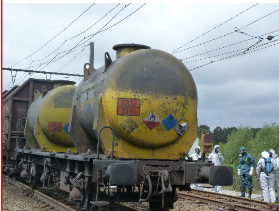
Photos des dégâts provoqués par le feu aux wagons 8 à 13
