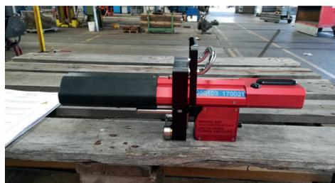
*Illustration : appareil de contrôle du profil de roue et de l'écartement entre les deux roues d'un essieu.*
