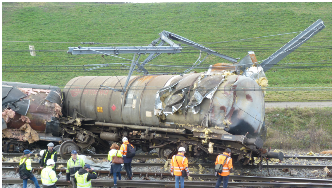
Photo : vue du premier wagon déraillé et des dommages à la caténaire
