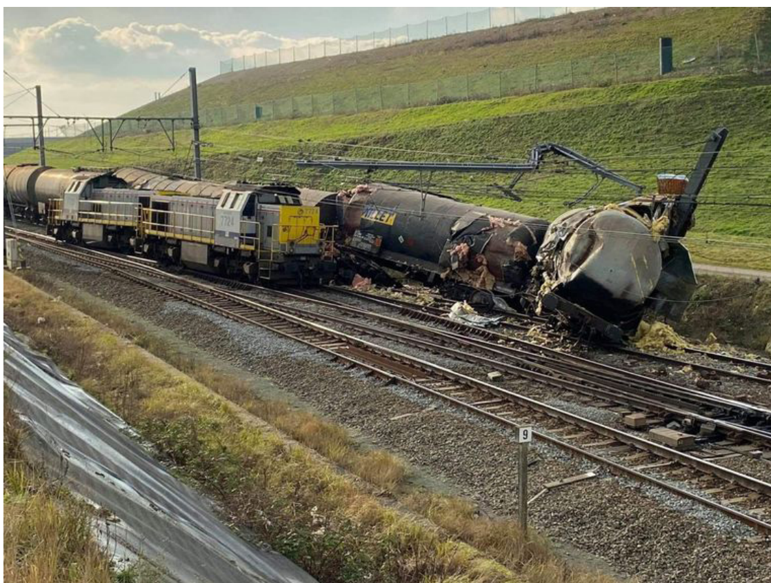
Photo : le déraillement des 2 locomotives du train LZ70080 et les dommages aux wagons du train E49826 (Source : Belga).
