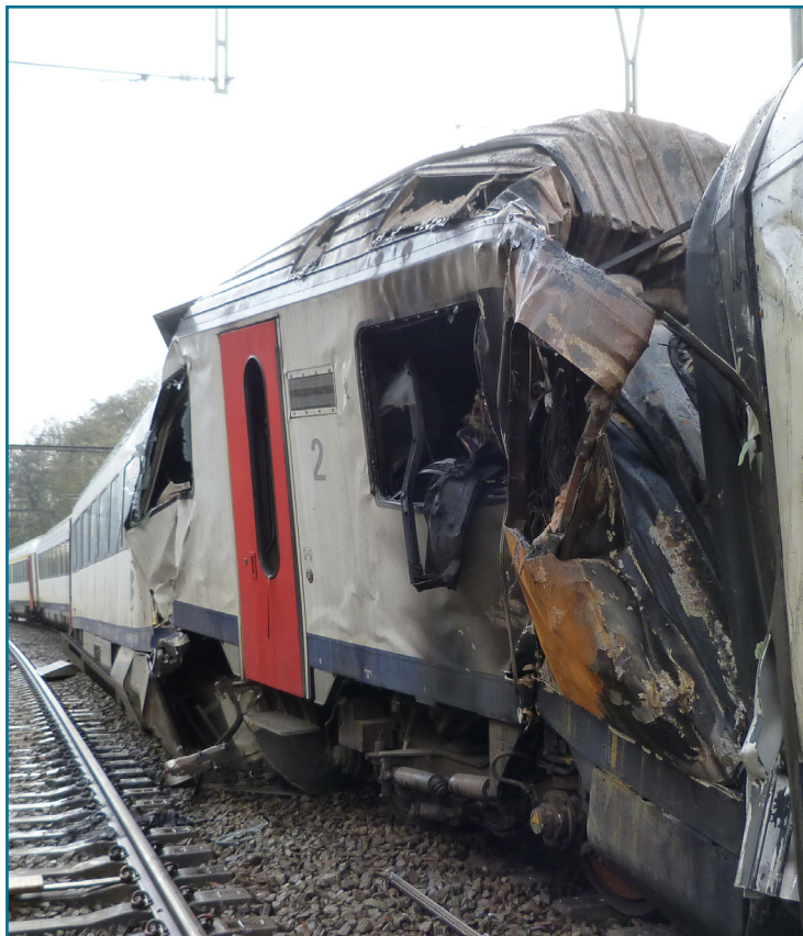
De voorkant van het eerste rijtuig van MS449, met de sporen van de brand, gebotst met de trein E940 te Bracquegnies.
