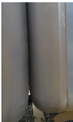
L'inconvénient de la présence de ces boudins pressés l'un contre l'autre est que les boudins ne permettent pas d'accéder au mécanisme de désaccouplement manuel se trouvant sur les coupleurs. Les automotrices AM96 sont dès lors pourvues d'un système de commande manuelle de désaccouplement dans les cabines de conduite : c'est une manivelle qui permet de transmettre l'effort au mécanisme par l'intermédiaire d'un câble et de sa gaine.
