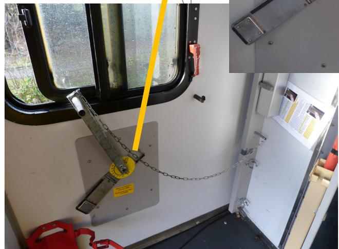
La rotation de la manivelle permet d'entraîner un câble (en jaune sur l'illustration ci-après) relié au levier de désaccouplement. La rotation de la manivelle entraîne une traction dans le câble<sup>4</sup>, ce qui se traduit par la translation du levier de désaccouplement et, par voie de conséquence, provoque la rotation de l'axe de la came (par l'intermédiaire de la crémaillère). Cela initie le désaccouplement pneumatique puis mécanique.
