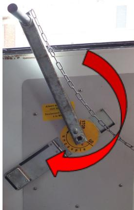
Pour ce faire, un opérateur a manipulé la manivelle dans la cabine de conduite située en queue de l'automotrice 442 (c-à-d du côté où se trouvait accouplée l'AM449).
