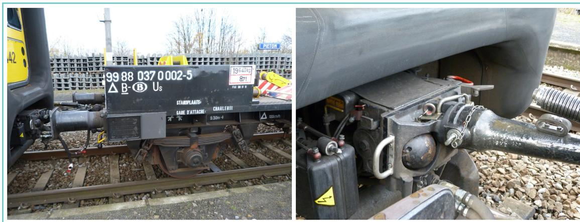
Une fois l'attelage de secours installé, l'essai de tirage est effectué et il est concluant (il permet de vérifier le bon état de l'accouplement mécanique).
