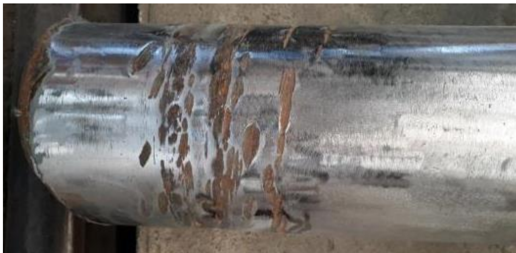
Figuur 78 : Uitzicht van wielas na schuren, kant van breukoppervlak
