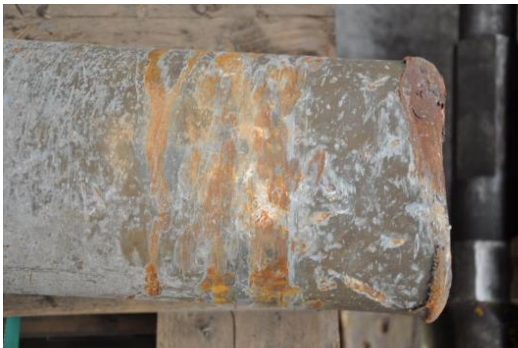
Figuur 36 : Uiteinde van wielas aan kant B, dicht van breukoppervlak
