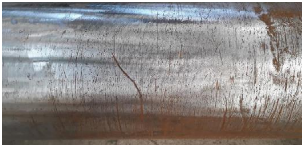
Figuur 76 : Uitzicht van wielas na schuren, middendeel
