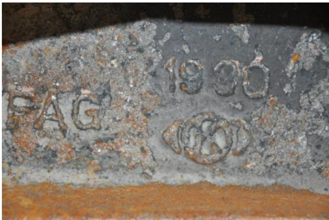
Figuur 66 : Merk op de wielasbus van wiel B
