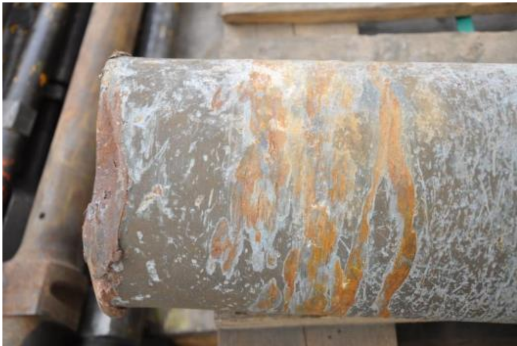
Figuur 39 : Uiteinde van wielas aan kant B, dicht van breukoppervlak
