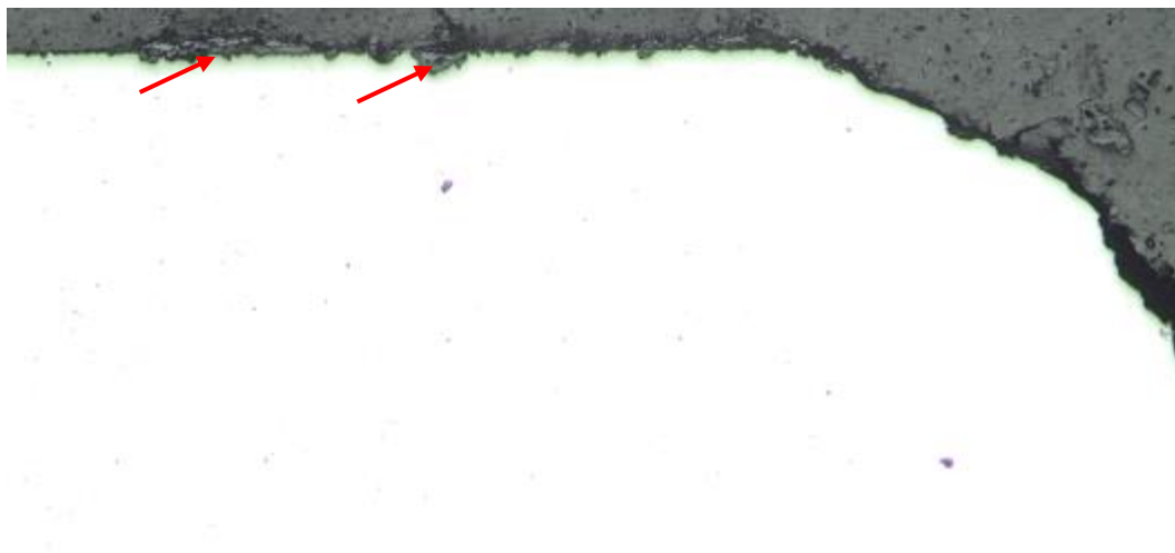
Figuur 105 : Corrosie aan wielnaafzitting op microsneede 1.1
