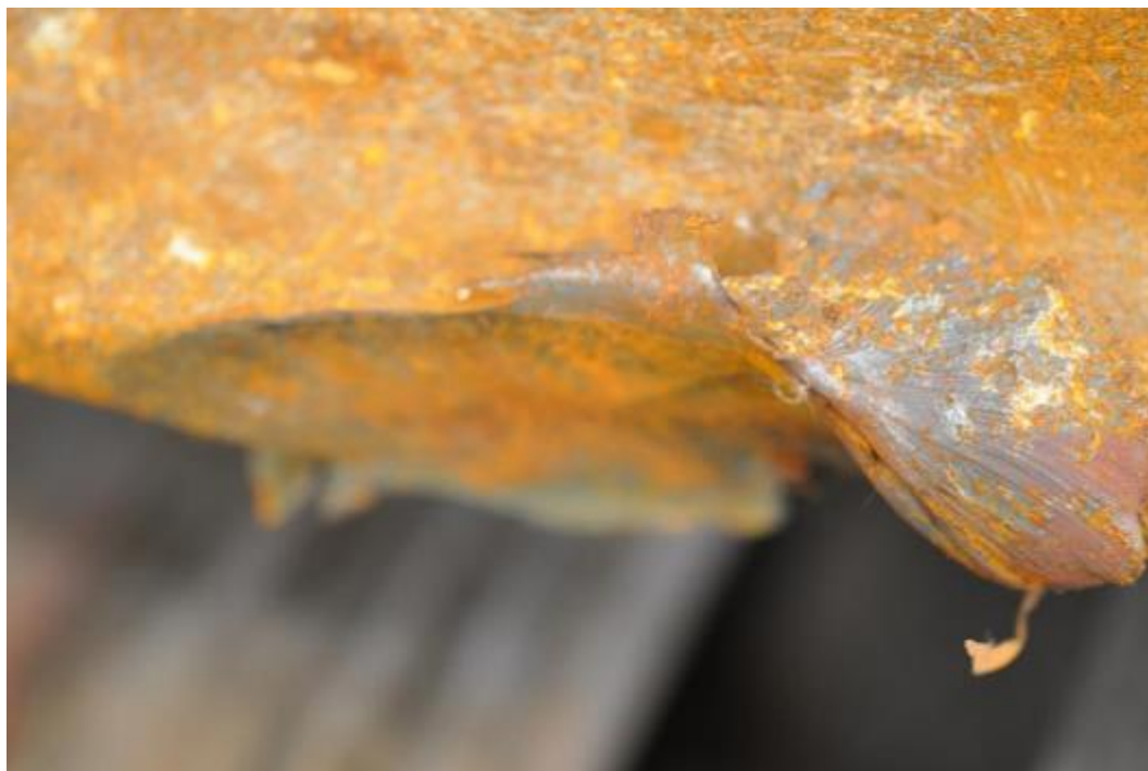
Figuur 17 : Slag van +/- 70 mm op de kraag van de wiel A
