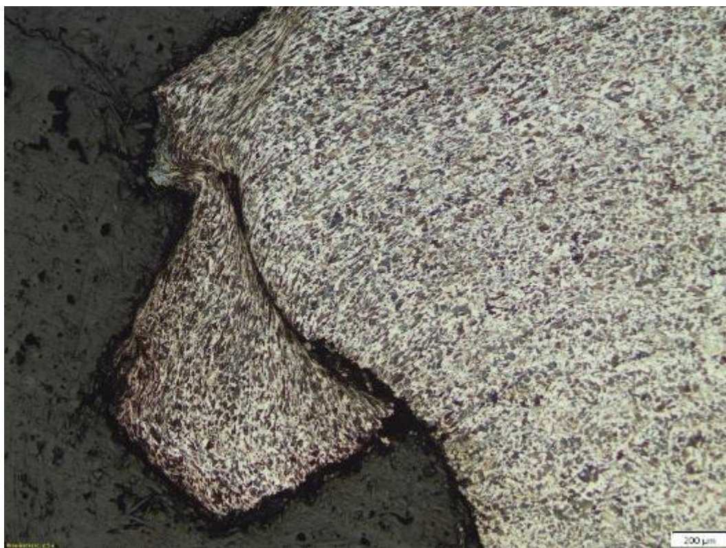
Figuur 112 : Micrografie 1.2 : aanzetpunt, Nital 1 %
