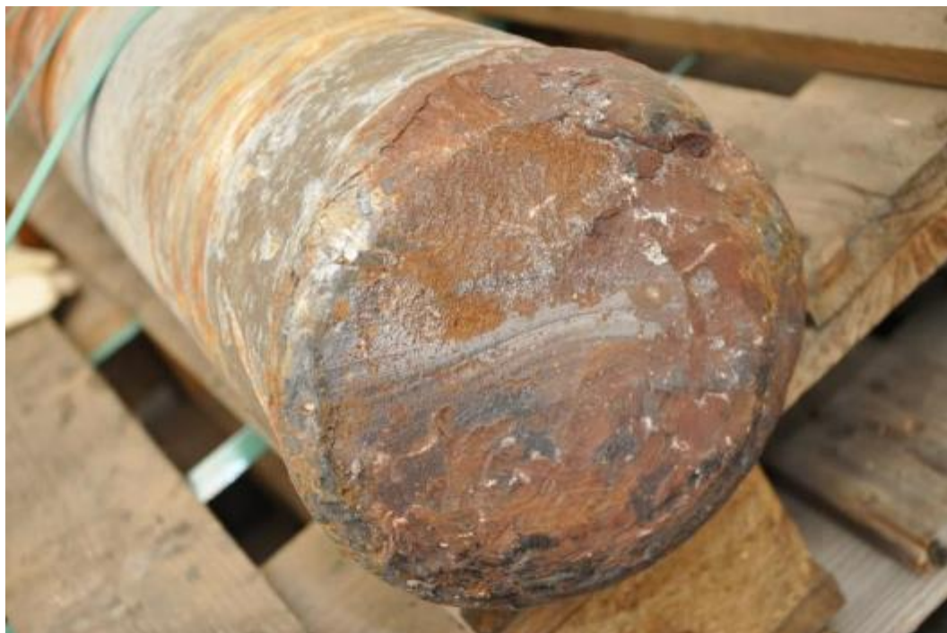
Figuur 33 : Breukoppervlak van kant B
