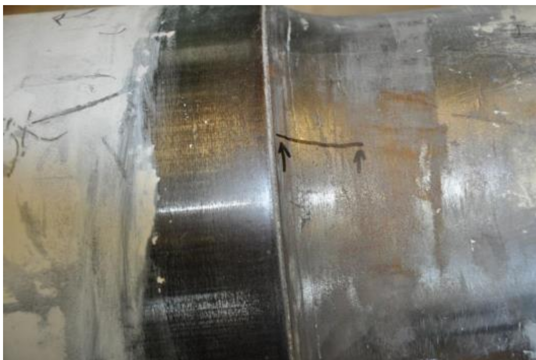
Figuur 99 : Detail van de indicatie in straal tussen wielnaafzitting en asschacht van wielas B – ligging van microsneede 1.1
