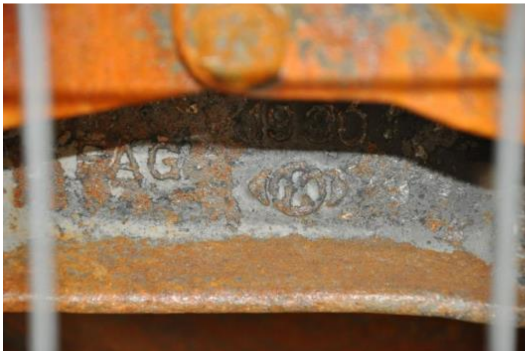
Figuur 63 : Merk op de wielasbus van wiel B
