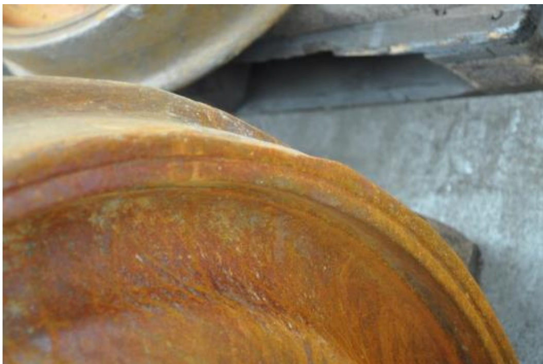
Figuur 52 : Beschadiging op de loopvalk van wiel B
