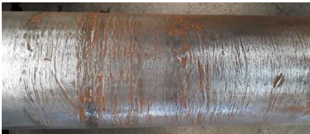
Figuur 74 : Uitzicht van wielas na schuren, middendeel
