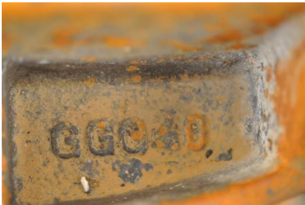
Figuur 8 : Merk op wielasbus van wiel A
