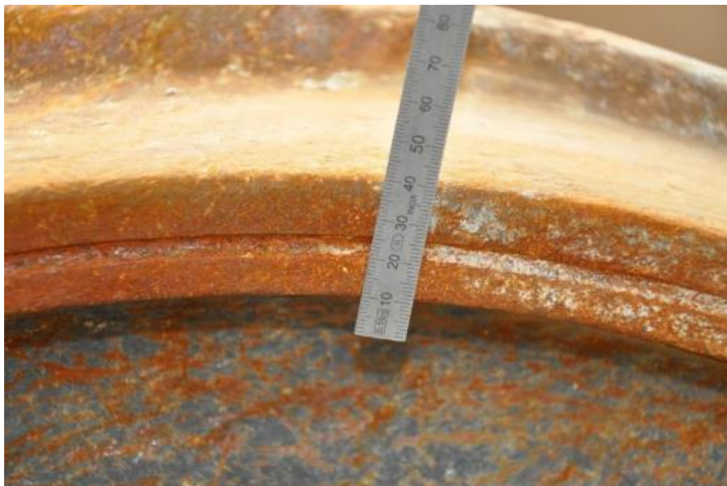
Figuur 55 : Sleetgroef van wiel B
