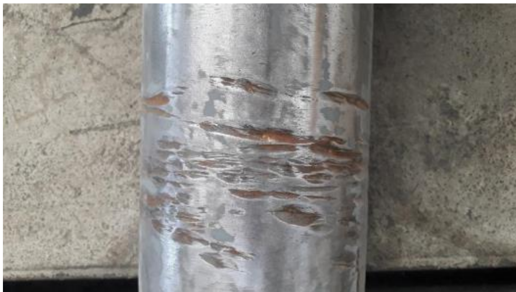
Figuur 77 : Uitzicht van wielas na schuren, kant van breukoppervlak
