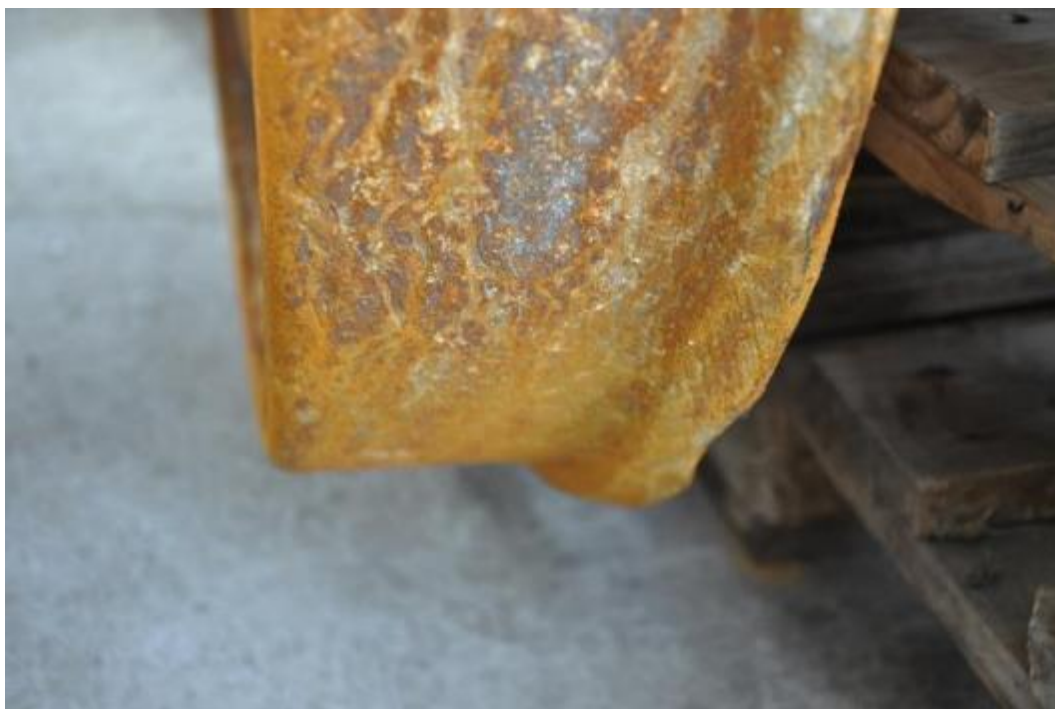
Figuur 48 : Beschadiging van kraag van wiel B
