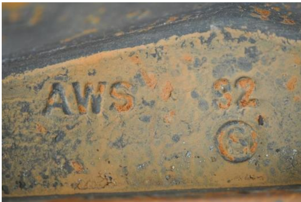
Figuur 6 : Merken op wielasbus van wiel A
