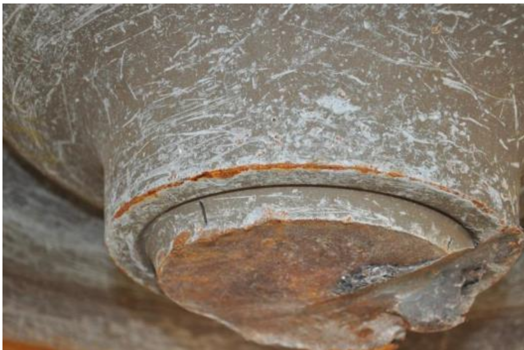
Figuur 13 : Uitzicht van breukoppervlak aan de kant van de wiel A – vermoedelijk aanzetpunt
