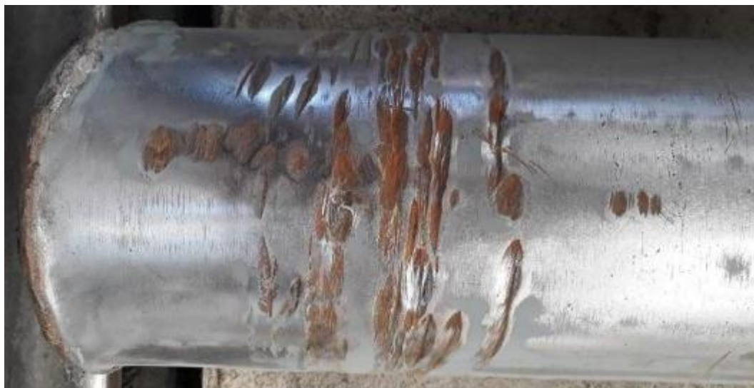
Figuur 79 : Uitzicht van wielas na schuren, kant van breukoppervlak
