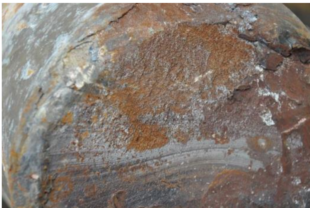
Figuur 34 : Breukoppervlak van kant B
