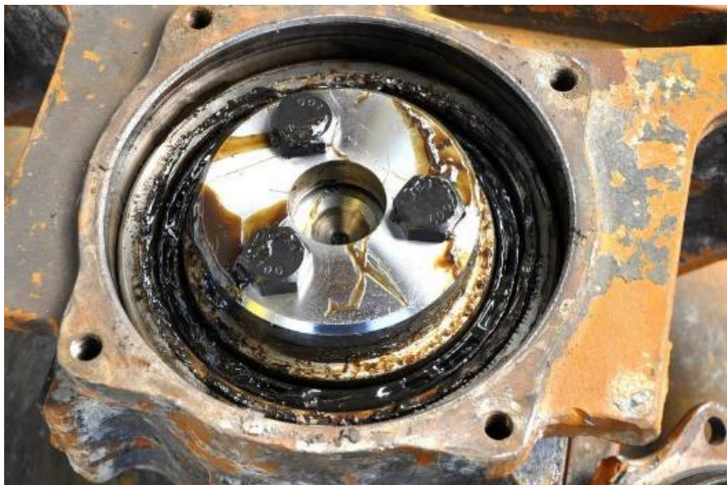
Figuur 27 : Uitzicht van binnendeel van wielasbus van wiel A na opening van de deksel
