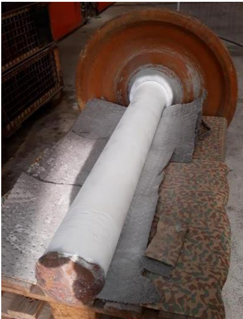
Figuur 80 : Wielas B geverfd voor magnetisch onderzoek
