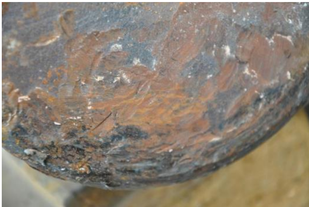
Figuur 35 : Breukoppervlak van kant B
