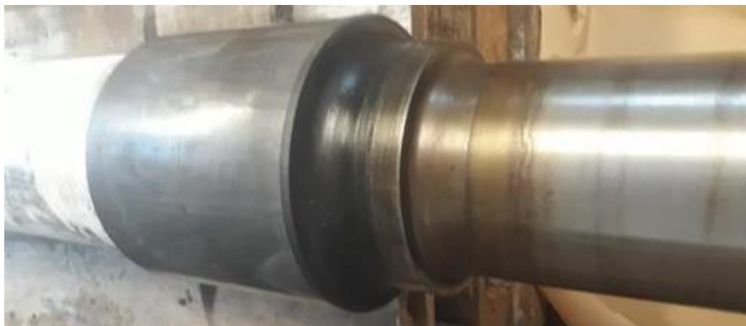
Figuur 87 : Uitzicht van astap en wielnaafzitting van wielas B na demontage
