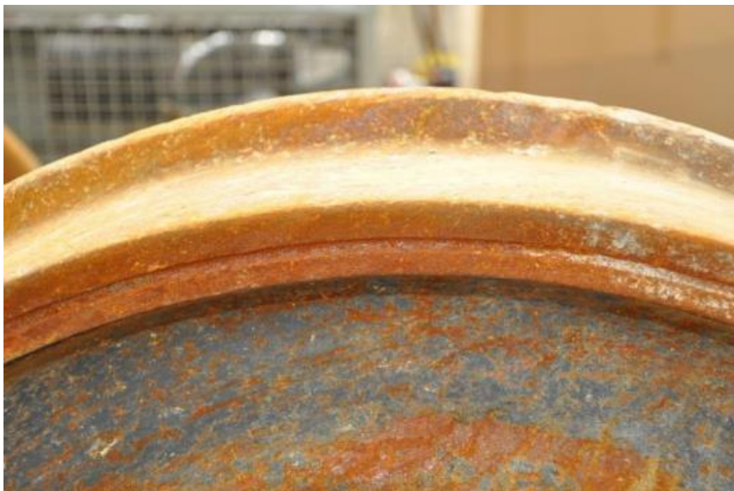
Figuur 51 : Sleetgroef van wiel B
