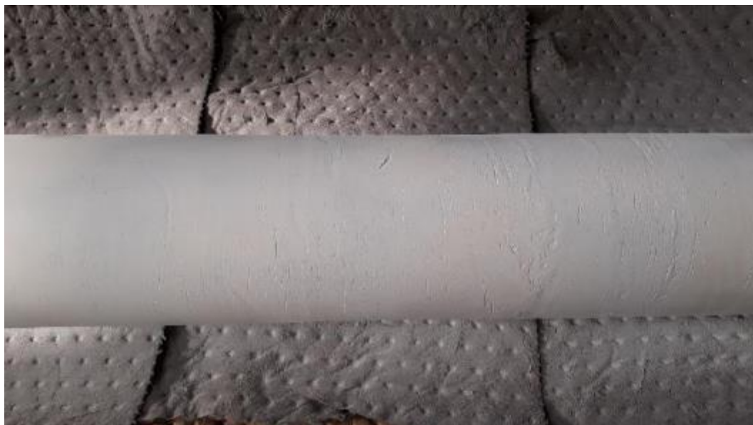
Figuur 82 : Wielas B geverfd voor magnetisch onderzoek, middendeel
