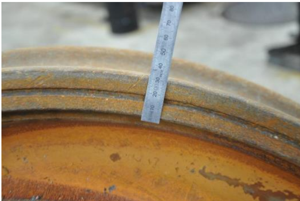
Figuur 23 : Sleetgroef van de wiel A, buitenkant van wiel
