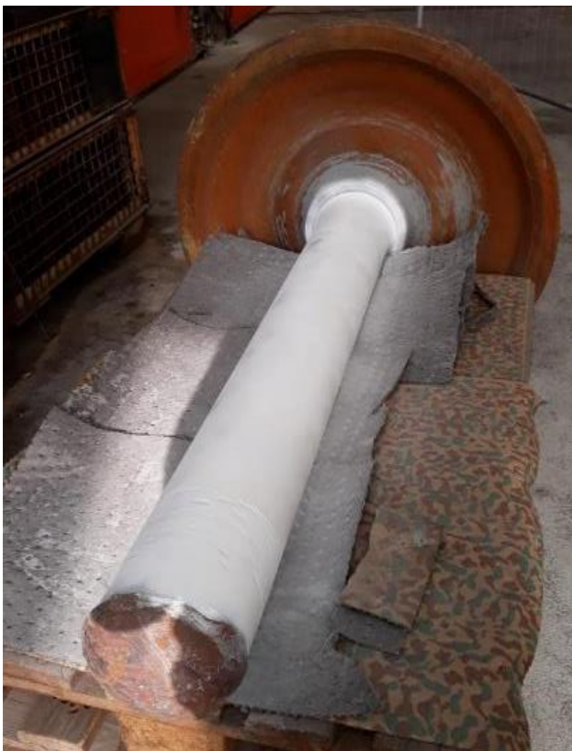
Figuur 80 : Wielas B geveerd voor magnetisch onderzoek
