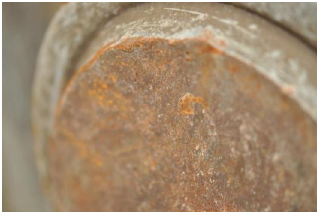
Figuur 11 : Uitzicht van breukoppervlak aan de kant van de wiel A
