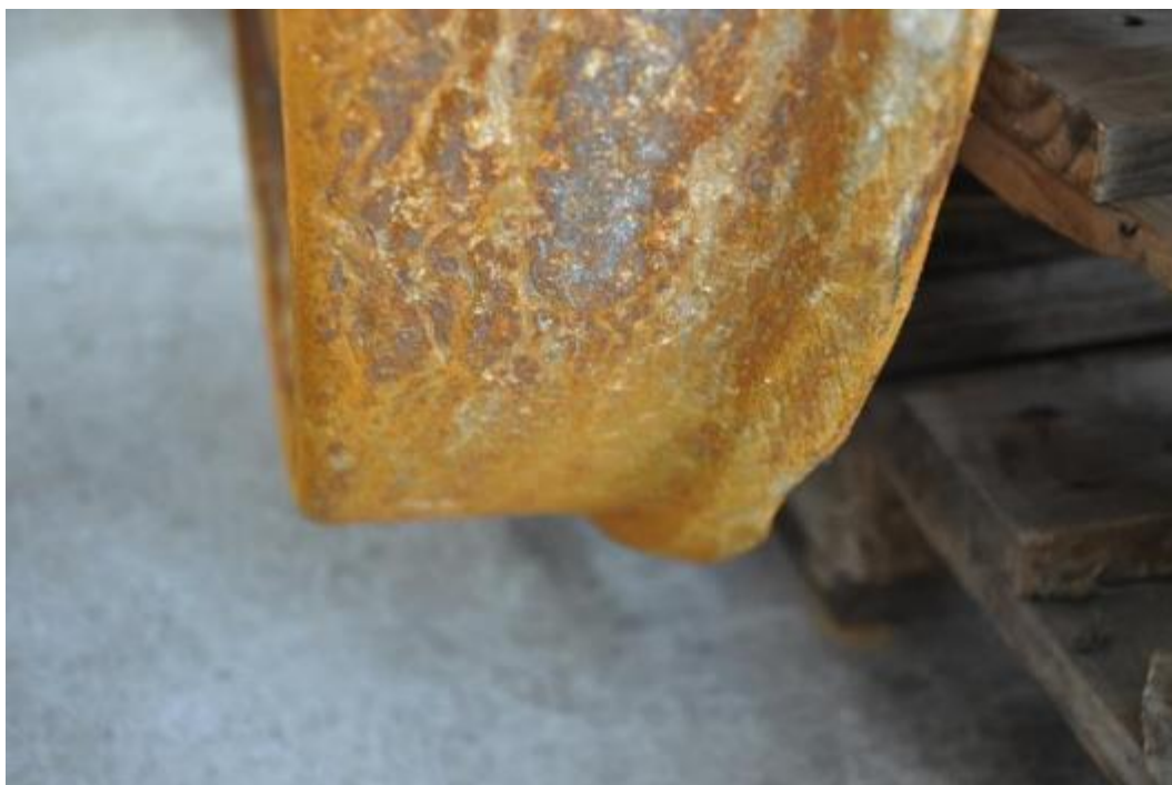
Figuur 48 : Beschadiging van kraag van wiel B
