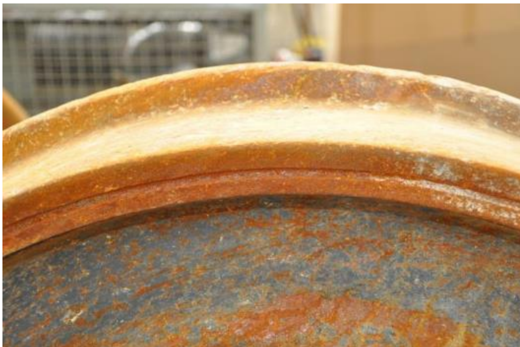
Figuur 51 : Sleetgroef van wiel B
