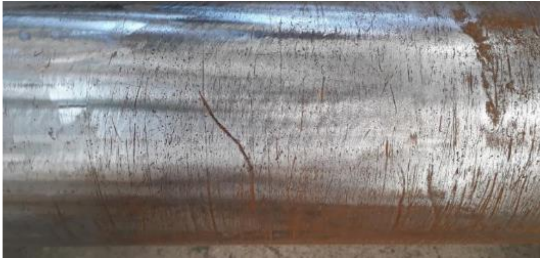
Figuur 76 : Uitzicht van wielas na schuren, middendeel
