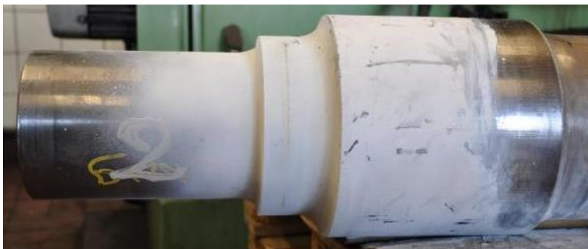
Figuur 95 : Uitzicht van astap en wielnaafzitting van wielas B na magnetisch onderzoek
