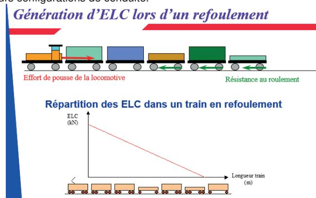
Figure 10 : Génération d'ELC lors d'un refoulement
