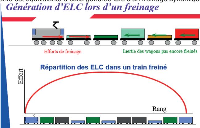
Figure 11 : Génération d'ELC lors d'un freinage
