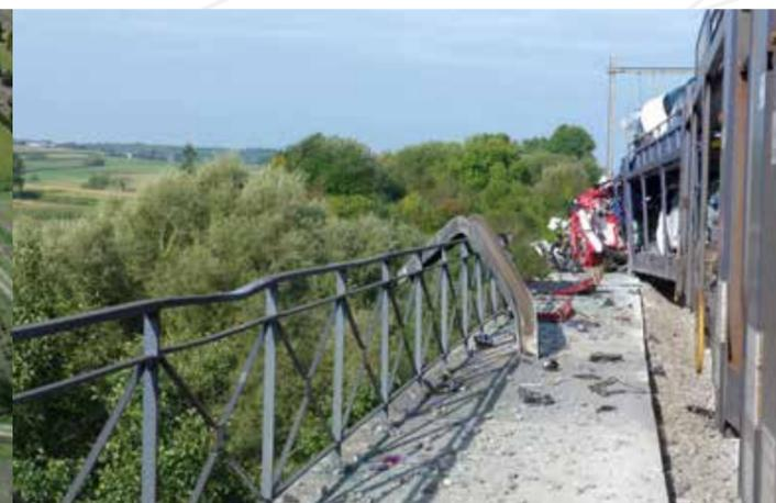
Dans la zone des aiguillages ramenant le convoi de la contrevoie à la voie normale, les sept premiers wagons du train dérailent. Trois des wagons-citernes sont percés durant le déraillement, et leur contenu toxique et inflammable se déverse dans le fossé, juste à côté des voies. Après le déraillement, le conducteur lance une alarme GSM-R.
